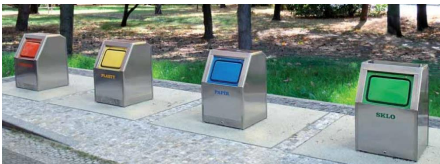
Obr. č. 5: Podzemní kontejnery
