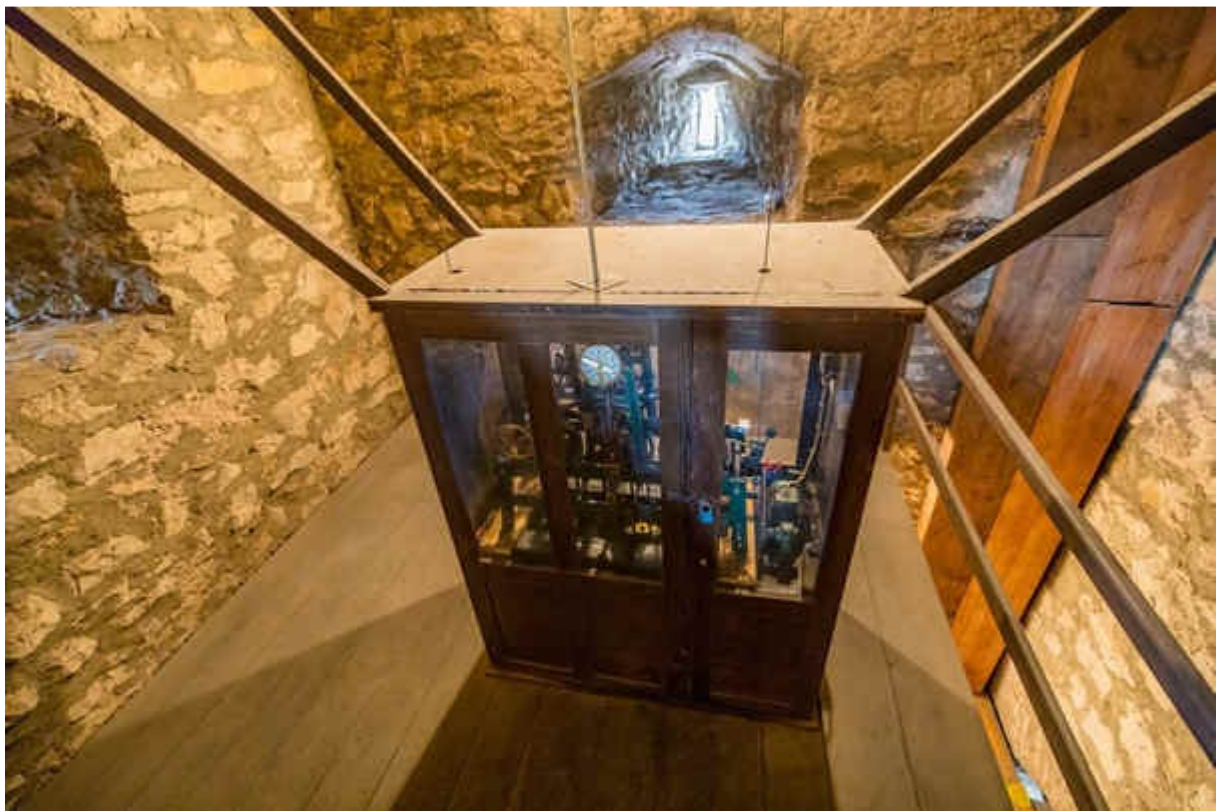
Hodinový stroj v patře pod zvonící ovládá ručičky na cifernících do všech světových stran.
